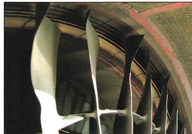
▲鳥擊過的引擎葉片會變形，有掛鋁質鴿子腳環或鳥類繫放金屬環的更會造成葉片的碎裂，碎片會深入發動機內部形成更大的連鎖破壞。想要感覺一下引擎葉片變形後的感覺嗎？把家裡電風扇其中一片扇葉葉尖掰掉一小塊，再以最高速運轉，就可以感覺到不一樣了。
