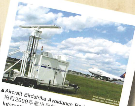
▲MARS在工作時可以升高天線以求取更大的掃描視野，這是經過改良的第二代產品。ABAR使用了相同的理念，同時增加了一組垂直（或水平）天線的功能，以求取3D效果。
