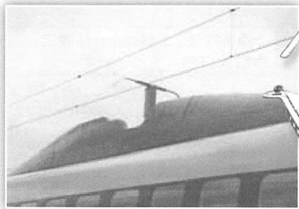
▲ 500 系列電車車頂上之翼型集電装置 (照片提供 JR 西日本)
