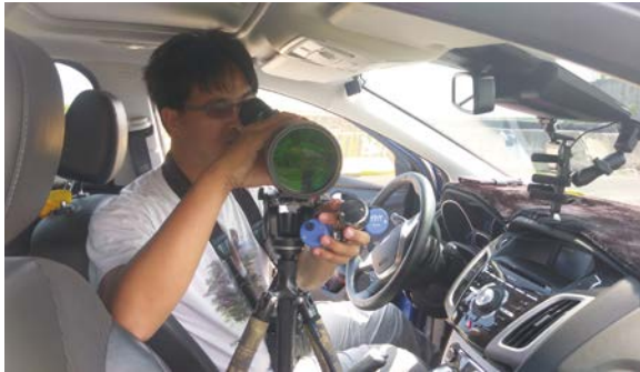
圖五： 在車內架設單筒望遠鏡的方法，建議使用四截腳架如圖中之 Gitzo 1542T。
